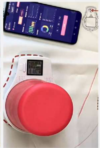
产品尺寸: 164*120*132mm 按压深度: 0~6cm(检测精度0.5cm) 按压力度: 0~32公斤 吹气量: 0~600ml(检测精度0.5ml)
